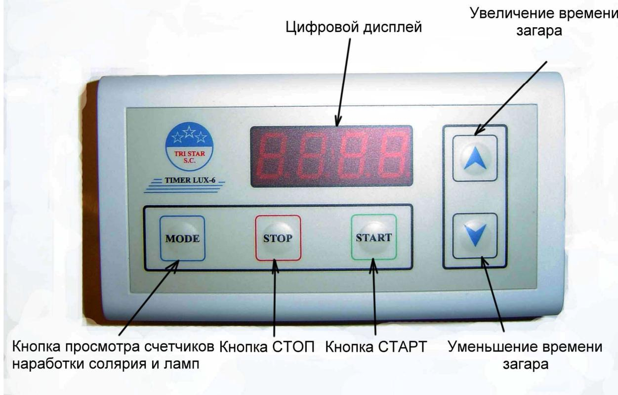
При подаче электропитания на солярий высвечивается номер версии программного обеспечения и устанавливается время сеанса загара 15 минут, лампы и вентиляторы солярия выключены. Изменить время сеанса загара возможно кнопками увеличения и уменьшения времени загара (от 1 до 60 минут). Солярий можно включить при помощи кнопки СТАРТ на панели управления микроконтроллера или внешней кнопки СТАРТ (пример использования внешней кнопки будет дан ниже).
